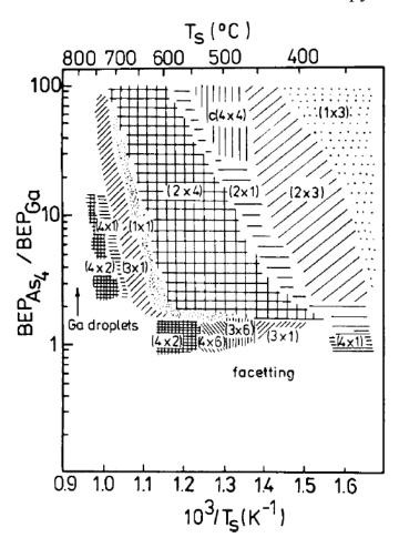
Рисунок 1.3 – Зависимость реконструкции поверхности от температуры поверхности и соотношении потоков Ga и As
