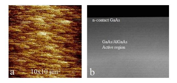
Рисунок 1.11 – (a) – АСМ изображение поверхности выращенной структуры: длина террасы - 0,7  $\sim$  0,96 мкм, среднеквадратичная шероховатость - 2 Å; (б) – ПЭМ изображение выращенной структуры
