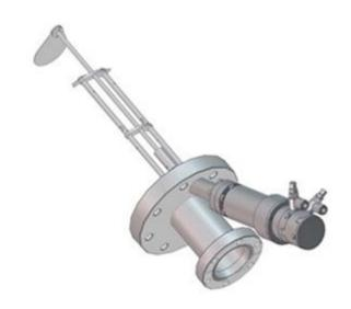
Рисунок 1.8 – Изображение строения заслонки эффузионного источника третьей группы
