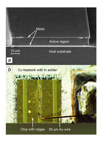
Рисунок 1.12 – Микрофотография сколотого торца излучателя (a) и фотография прибора, смонтированного на медном теплоотводе (b)
