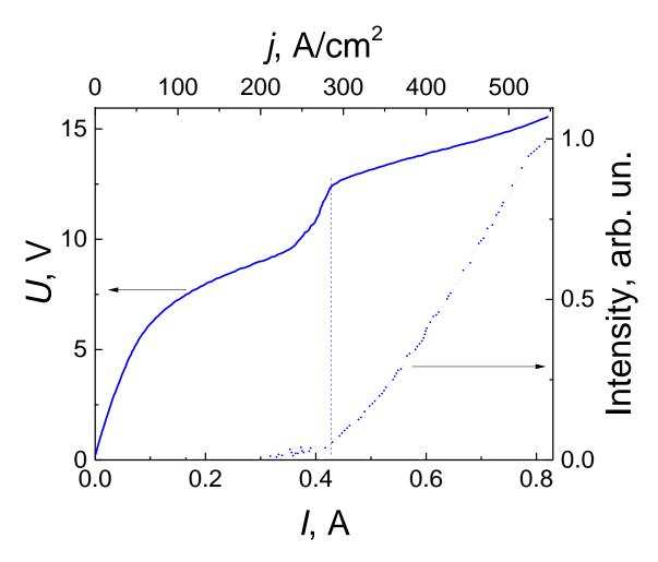
Рисунок 1.13 – ВАХ (сплошная линия) и зависимости интенсивности излучения от тока (точечная линия) исследуемой каскадной структуры
