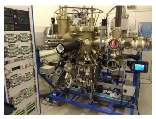
Рисунок 1.1 – Установка молекулярно-пучковой эпитаксии RIBER Compact 21
