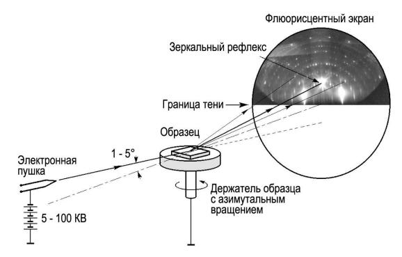
Рисунок 1.2 – Принципиальная схема системы ДБЭО в камере установки молекулярно-пучковой эпитаксии
