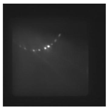
Рисунок 1.4 – Типичная картина ДБЭО после сгона окисла с калибровочной пластины GaAs(100) в направлении [0-11]
