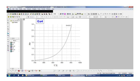
Рисунок 1.7 – Экспериментальная зависимость скорости роста GaAs от температуры источника галлия
