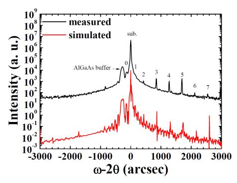
Рисунок 1.10 — Рентгеновские кривые качания структуры ККЛ вблизи отражения GaAs (004): экспериментальная и теоретическая
