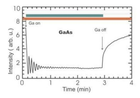
Рисунок 1.6 – Типичное изображение на экране компьютера при измерении скорости роста GaAs слоя
